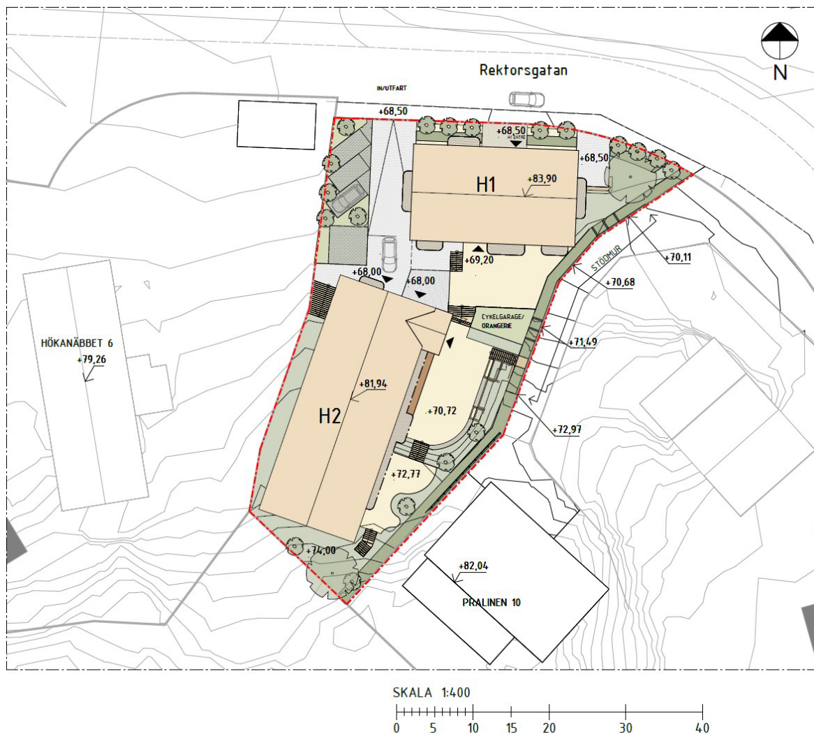
Figur 29 Utvecklingsskiss med plushhöjder på markens nivåer i relation till omgivande terräng samt för avrinning till de två föreslagna dikena, illustration: RStudio.
