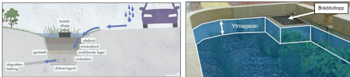
Figur 22 Sektion av biofilter intill köryta och fördröjningsvolym ovanpå filterbädd, illustrationer: Sweco.
